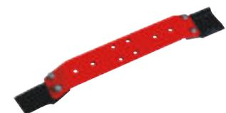
Die Grundgeräte sind mit zwei Messerkreisen ausgestattet, die einen großzügigen Überschnitt ermöglichen und somit ein sauberes Schnittbild gewährleisten. Die Messer sind auf Messerträgern montiert, wodurch ein kostengünstiger Austausch der Klingen ermöglicht wird.
