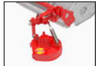
Mechanische Steuerung für Mulchkopf
