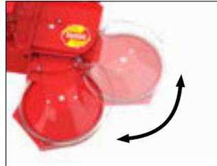
Unter dem Messerkreis der Schwenkscheibe befindet sich ein Messerstützteller, der den Schwenkarm dem Gelände anpasst.
