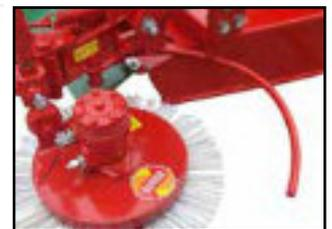
Mechanische Steuerung für Fräskopf
