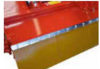
Zusätzlicher Gummi-Steinschlag-schutz im Heckbereich
