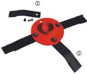
Pro Messerkreis sind zwei bewegliche, frei pendelnde Messer montiert, die ein sauberes und exaktes Schnittbild liefern. Zusätzlich können an die Messerronde zwei Schnittholzmesser ① angebracht werden, um leichtes Gehölz bis Ø 3 cm zu zerkleinern.
