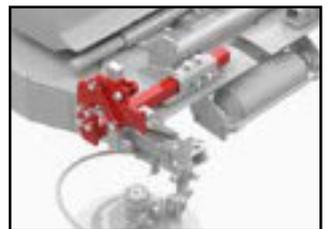
Adapter für Aufnahme mechanische Steuerung für Fräskopf an LV
