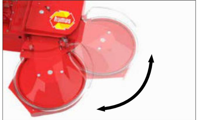
Durch die elektrohydraulische Präzisionssteuerung ertastet ein vor dem Schwenkarm positionierter Taktfühler den Stamm äußerst feinfühlig und führt die Schwenkmulchscheibe millimetergenau um das Hindernis. Dadurch können Baumstämme, Rebstöcke, Sträucher, Weidezäune – und selbst Flächen unter Solarpanelen – objektnah und schonend abgetastet sowie gemulcht werden.
