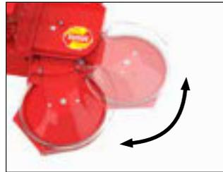
Durch die elektrohydraulische Präzisionssteuerung ertastet ein vor dem Schwenkarm positionierter Taktilefühler den Stamm äußerst feinfühlig und führt die Schwenkmulchscheibe millimetergenau um das Hindernis. Dadurch können Baumstämme, Rebstöcke, Sträucher, Weidezäune – und selbst Flächen unter Solarpanelen – objektnah und schonend abgetastet sowie gemulcht werden.
