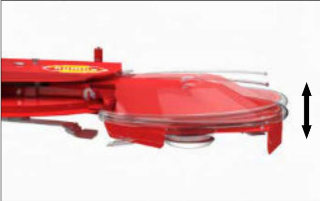
Unter dem Messerkreis der Schwenkscheibe befindet sich ein Messerstützteller, der den Schwenkarm dem Gelände anpasst.
